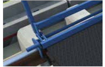
Den Einbauhebel öffnen und unter dem Schienenkopf einhaken.
