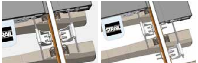
Bild 1: Bündig abschließender Bahnübergang
