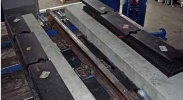
Présentation des pièces compensatrices et des éléments extérieurs et intérieurs profilSTRAIL .
